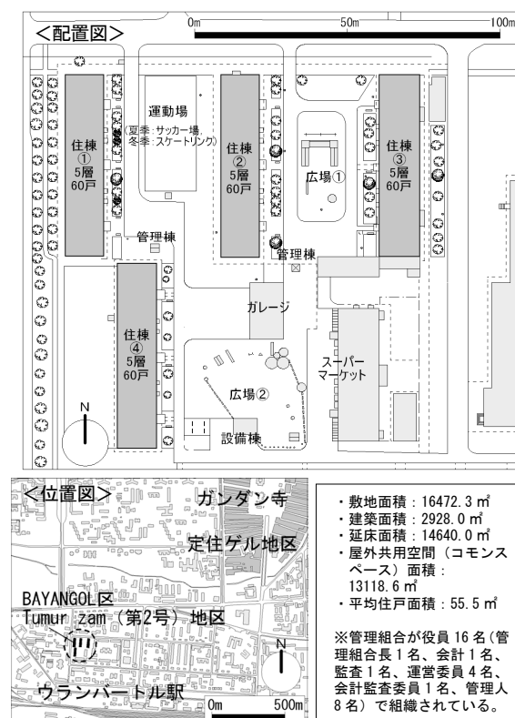
図1 調査対象集合住宅〔BAYANGOL 区 TUMUR ZAM（第2号）地区〕
